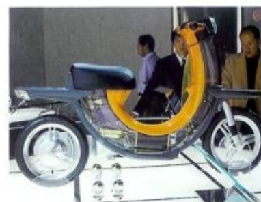
Fig. 3 – Silencieuse, peu gourmande, la pile à combustible au méthanol assure la locomotion de ce scooter.
