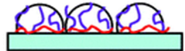
Conformation du polymère sur la surface minérale chargée
