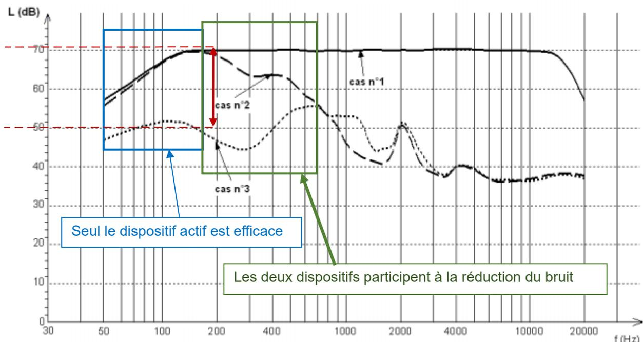
**2.2.** La notice mentionne une fonction réductrice de bruit pour le dispositif actif « **allant jusqu'à 20 dB** ». En mesurant l'atténuation apportée par le dispositif anti-bruit ( $= L_2 - L_3$ ), on constate que la diminution peut atteindre jusqu'à 20 dB mais uniquement **autour de la fréquence de 200 Hz**. **Souvent la diminution est inférieure à 20 dB**, mais la notice indique « jusqu'à 20 dB » ce qui est **une formulation juste** mais qui peut induire en erreur...
