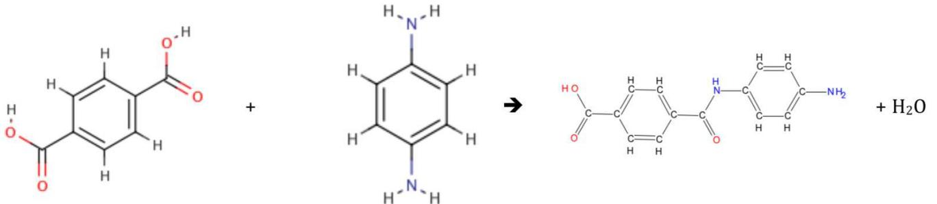
d) Écrire l'équation chimique de la réaction entre n molécules d'acide téréphtalique et n molécules de 1,4-diaminobenzène.
